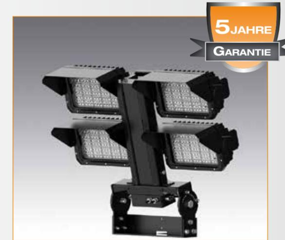
Die LED Flutlichter Amera mit bis zu 150 lm/W verfügen über eine spezielle Flügelkonstruktion mit der jedes Modul bis zu 360° vertikal und 90° horizontal gedreht werden kann. Das Gehäuse besteht aus einem hochwertigen ADC12-Aluminiumdruckgehäuse. Optional ist für jedes Modul ein Blendschutz erhältlich, der die Lichtverschmutzung reduziert. Mit sechs Abstrahlwinkeln ist die Produktserie Amera für vielfältige Beleuchtungsszenarien geeignet.
