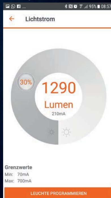
Einstellung d. Lichtstroms über ein Drehrad
