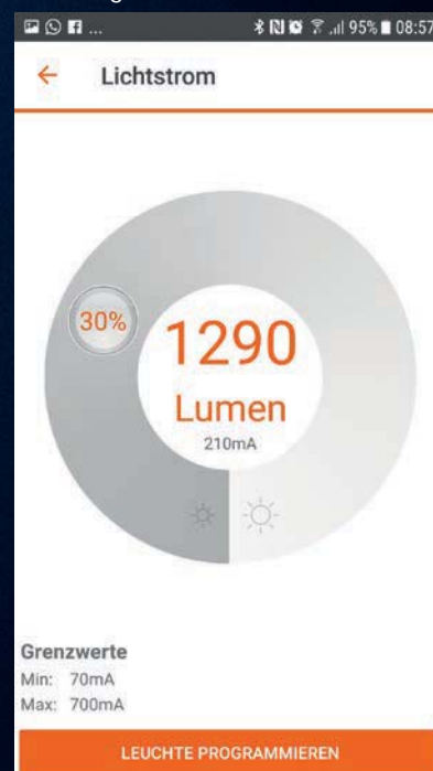
Einstellung d. Lichtstroms über ein Drehrad
